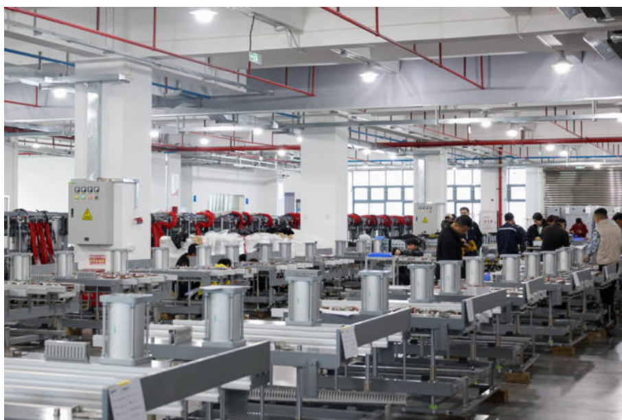
图 3-3 电池化成分容线体系统生产车间图
